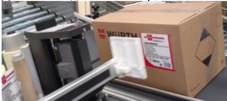
Большая длина хода штампа в сочетании с точным управлением шагового двигателя позволяет использовать аппликатор eTamp от Evolabel не только для нанесения этикеток на боковую и верхнюю поверхность коробок разного размера, но и для этикетирования паллет. Если паллета размещена на поворотном столе, большая зона досягаемости аппликатора eTamp позволяет нанести этикетку на любую или сразу на несколько сторон паллеты.
