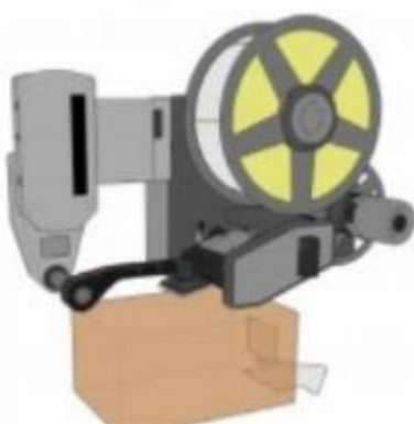
Этикетирование передней поверхности
