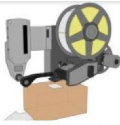
Этикетирование верхней поверхности при обратном направлении
