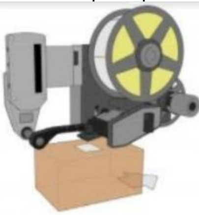
Этикетирование верхней поверхности
