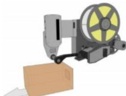
Этикетирование задней поверхности
