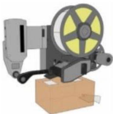
Нанесение на верхнюю поверхность двух этикеток
