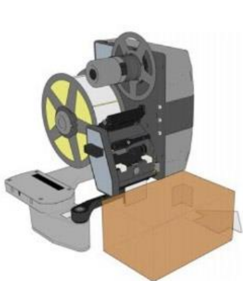
Нанесение этикеток на углы
