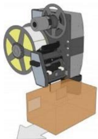
Нанесение двух этикеток на боковую поверхность
