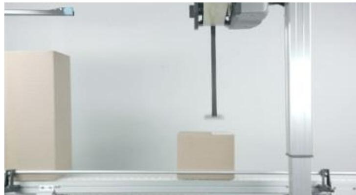
Шаговый двигатель, регулируемый импульсным энкодером, приводит в движение вал из углеводородного волокна, который крепко удерживает этикетку с помощью запатентованного передающего штампа, напечатанного на 3D принтере; штамп быстро двигается к цели и с высокой точностью наносит этикетку. Датчик измерения высоты упрощает процесс установки и обеспечивает нанесение этикетки в нужное место, даже если высота упаковок изменяется в произвольном порядке, а скорость конвейера достигает 80 м/мин.
