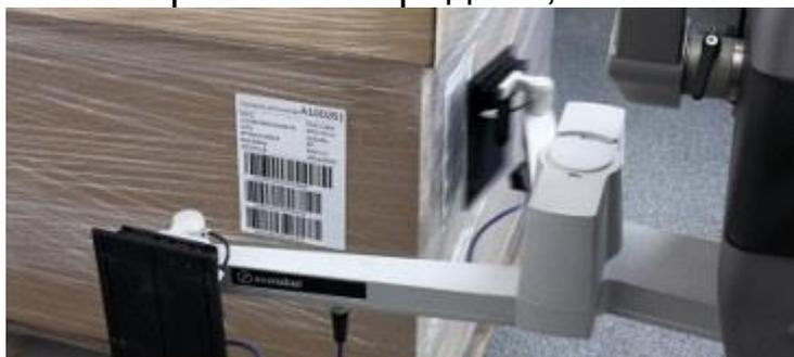
С помощью технологии нанесения этикетки свободным движением (патентная заявка) одна и та же конструкция может в течение 12 секунд этикетировать каждую из двух смежных сторон (боковую + переднюю или боковую + заднюю). Этот процесс включает валидацию всех штрих-кодов на этикетках с серийным номером транспортной упаковки (SSCC), присвоенным по стандартам GS1. Система FlexWire позволяет нанести этикетку на все три стороны без остановки паллеты, если не требуется контрольное сканирование.
