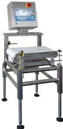
Автоматические динамические весы серии DWT/RC/HYF предназначены для встраивания в уже имеющуюся технологическую линию пищевой промышленности, где основными проблемами являются высокая влажность и частая мойка под высоким давлением.
